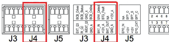
Рисунок 21 – Сухие контакты аварийных оповещений
